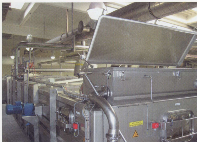
In der Tetra Tebel Alfomatic wird der Bruch entmolkt. Hier erfolgt die eigentliche Reifung des Mozzarellas
