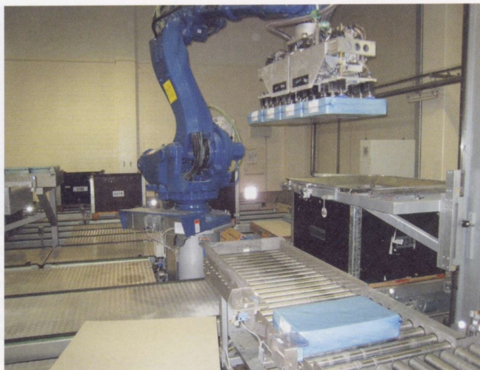
Der Abpack- und Umpackprozess der Blöcke erfolgt automatisch mittels Robotertechnologie
