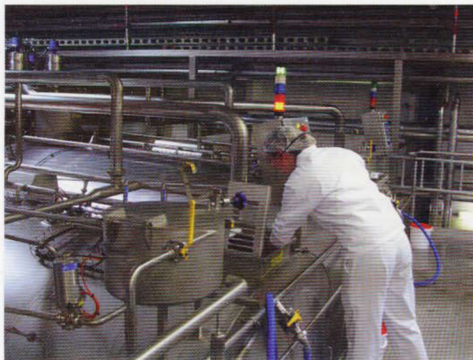
Die Prozesse in den Fertignern laufen automatisch, nur die Probenahme erfolgt noch von Hand (Foto: DMW)
