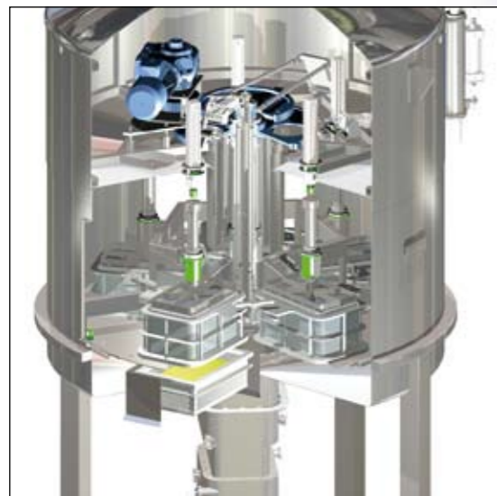
Doorsnede van de Conomatic ter hoogte van de kaasinsertiepositie Querschnitt der Conomatic in der Höhe der Käseinsertieposition Cross-section of the Conomatic at the cheese insertion position.
