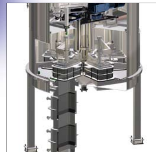
Doorsnede van de Conomatic ter hoogte van de drainerkolom en de vulpositie van de vormkamer Querschnitt der Conomatic in der Höhe der Ablaufsäule und der Füllposition der Formkammer. Cross-section of the Conomatic at the drainage column and the forming chamber filler position.
